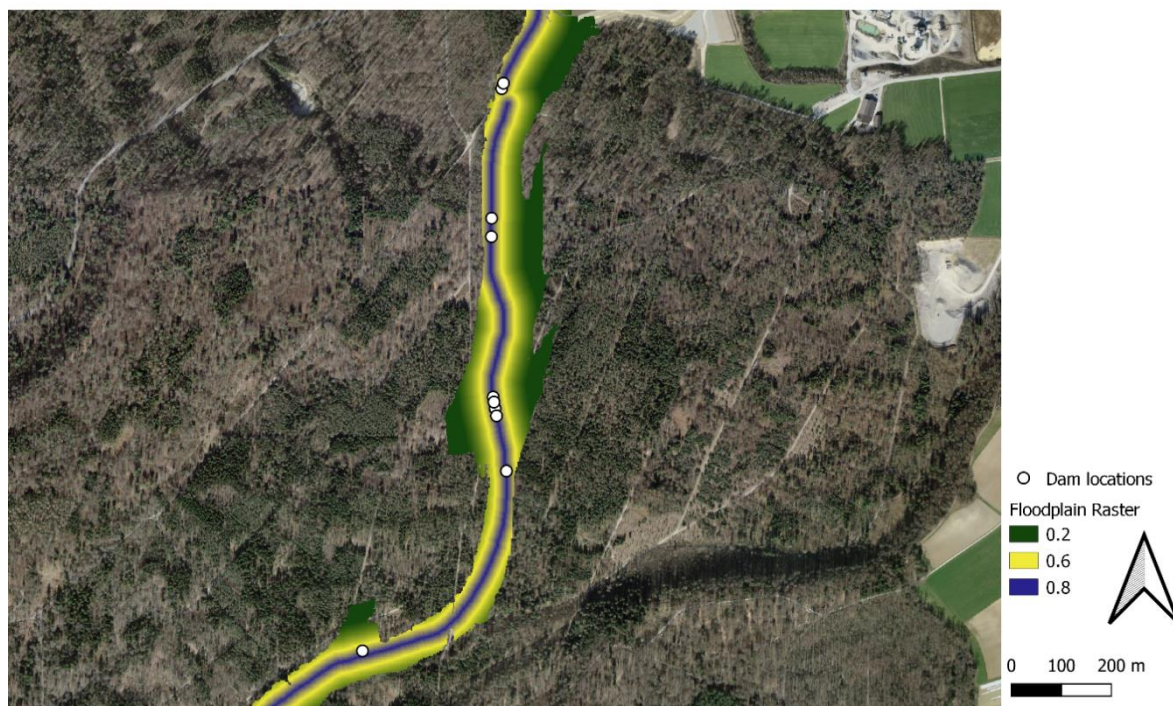
Figura 3: Griglia della pianura alluvionale di Beaver per delineare la probabilità di inondazione. Verde=bassa probabilità di inondazione; blu=alta probabilità di inondazione.
