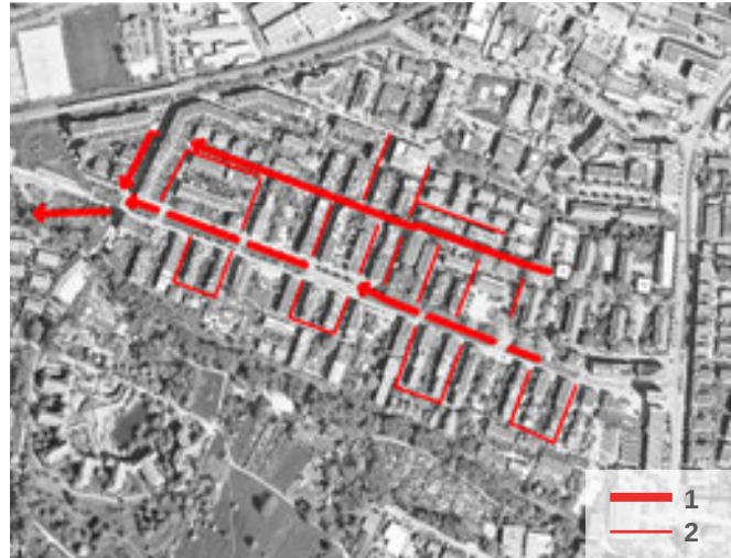
Abb.4 Mulden-Rigolen-Systeme MRS (1) und Regenwasserrinnen (2)
