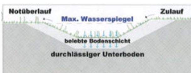
Abb. 49: Versickerung und Retention von Niederschlagswasser im Liegenschaftsbereich (Quelle: KBOB)
