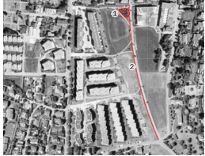
Abb.4 Der Widmi-Teich (1) wird u.a. über die Wasserrinne (2) gefüllt.
