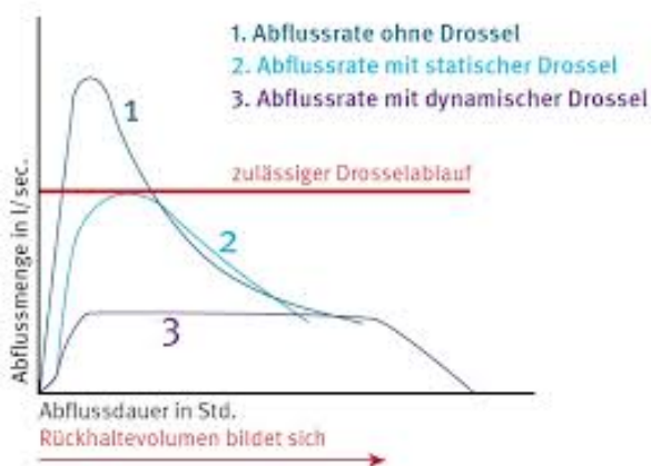
Abb. 71: Prinzipskizze: Drosselung des Abflusses (Quelle: T. Oesch)
